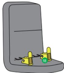
Installez d'abord les deux guides (18) des connecteurs ISOFIX sur les ancrages ISOFIX du véhicule. (Si le siège de votre véhicule est équipé de guides ISOFIX intégrés, vous pouvez passer cette étape.)
