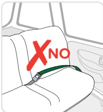
! Votre siège auto doit **UNIQUEMENT** être installé sur un siège muni d'une ceinture à 3 points d'ancrage.
